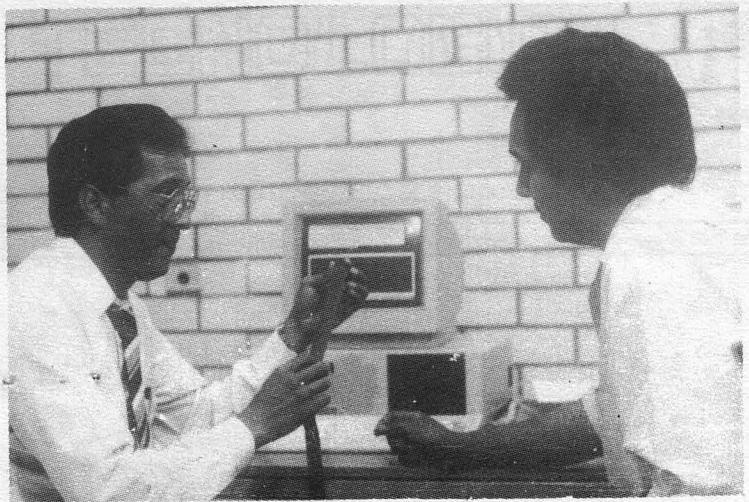
La cinta perforada contiene la combinación de la llave.
